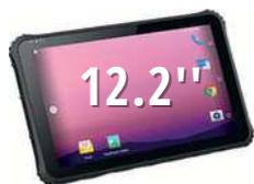
Android 10 GMS. 4 Go Ram, 64 Go SSD, Qualcomm Snapdragon 625 2Ghz OctoCore, écran tactile capacitif 1920 x 1200 10 points, 300 nits, GPS. Wifi 802.11 b/g/n/ac, Bluetooth Rev 4.2. Caméra arrière 13 Mpixels autofocus et avant 5 Mpixels, G sensor, 1 USB 3.0, 2 USB 2.0, USB Type-C, audio jack, mini HDMI, micro SD. RS232, RJ45, batterie échangeable 12600 mA 3,7V, IP65, 1,2m chute.
