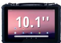
4 Go RAM 64Go ROM, Qualcomm SnapDragon 625 2Ghz OctoCore, écran tactile capacitif et digitizer 1280 x 800 px, 700 nits, GPS. Wifi 802.11 b/g/n/ac, Bluetooth Rev 4.0. Caméra arrière 13 Mpixels autofocus et avant 2 Mpixels, G sensor, Capteur de luminosité, 1 USB 3.0, 1 USB-C 2,0, audio jack, mini HDMI, micro SD. RS232, RJ45, Batterie échangeable 10000 mA 3,7V, IP65, 1m chute.
