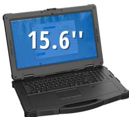
Ecran 15.6" full HD 1920 x 1080 700 nits, TPM 2,0, Wi-Fi haut débit 6, Bluetooth Rev 5.1. GPS. Caméra avant 2 Mpixels, Empreinte digitale, capteur de lumière, USB 2.0 Type-A x 1, USB 3.0 Type-A x 3, carte SIM x 1, prise audio, RJ45 Ethernet x2, HDMI x 1, SD card x 1, RS232 DB9 x 1, 5PIN Pogo Pin x1, Batterie remplaçable à chaud 6300 mA 7,4V, batterie interne 1750mA 7,4V, IP65, chutes de 1,2 m.
